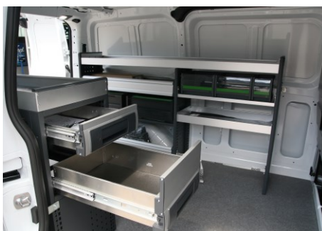
Auszüge bei Einbaublock rechts
